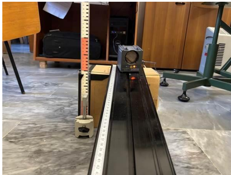
Figura 15: setup del piano inclinato con sonar
