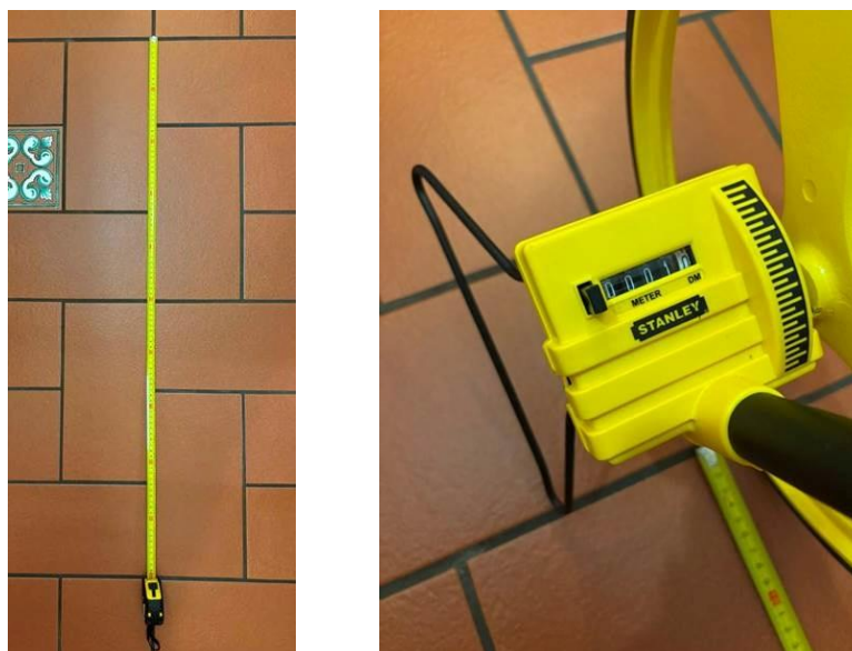
Figura 7-8: verifica del principio di funzionamento dell'odometro
