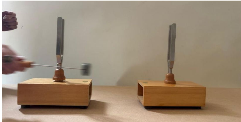
Figura 30: risonanza con due diapason alla frequenza della nota La_3 (440Hz)
