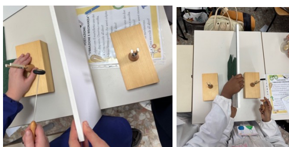
Fig. 9: Bambini che sperimentano diapason che vibrano a distanza con pannelli ostacolo
