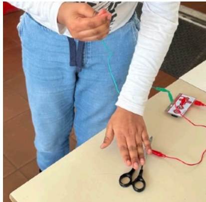
Figura 122: Il bambino collega alla scheda MakeyMakey le lame delle sue forbici per verificare se si trattasse di un materiale conduttore.
