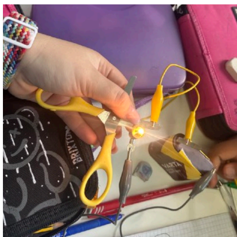
Figura 68: I bambini osservano la differenza tra il comportamento delle lame delle forbici e il manico, mettendo a punto la differenza tra conduttori e isolanti osservandone gli effetti.
