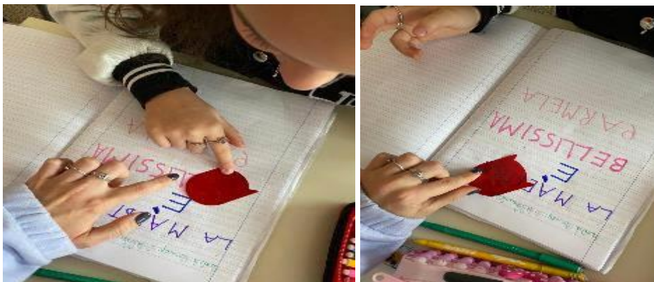
Figura 55: osserviamo come la scritta rosa scompare con il filtro rosso, invece quella viola è più scura.
