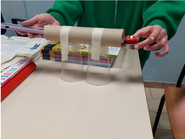
Figura 51: lo strumento presenta due aperture, da un lato è presente una candela accesa mentre dall'altro un generatore di toni che farà sì che la fiamma della candela oscilli
