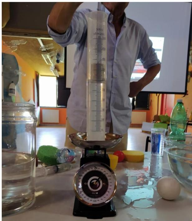
**Figura 18:** Il blocchetto viene immerso nell'acqua, determinando un innalzamento del livello dell'acqua e una variazione del peso sulla bilancia.
