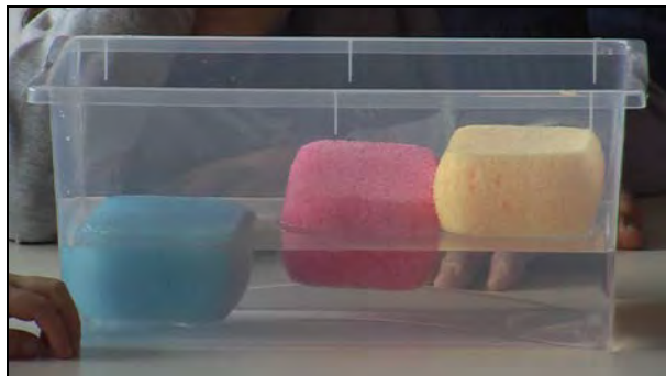
Versando acqua sulla spugna gialla il livello dell'acqua sale e la spugna gialla tende a immergersi di più
