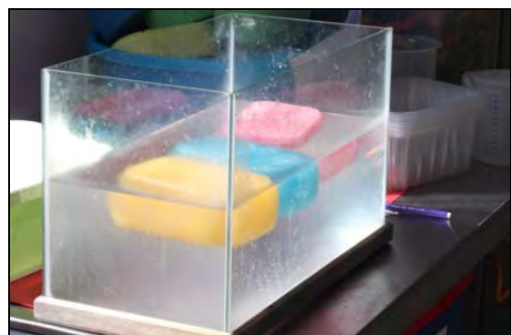
le tre spugne galleggiano con diversa altezza di immersione in funzione della quantità di acqua assorbita. Le spugne sono state lasciate come nella foto a sinistra. All'inizio della attività successiva le tre spugne galleggiano con la stessa immersione.
