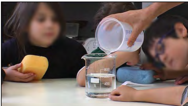
nel becher sono versati 600 ml di acqua. Mantenendo immersa tutta la spugna il pelo libero dell'acqua è quasi a 800ml.
