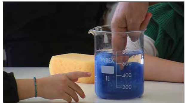
nel becher sono versati 600 ml di acqua. Mantenendo immersa tutta la spugna il pelo libero dell'acqua è quasi a 800ml.
