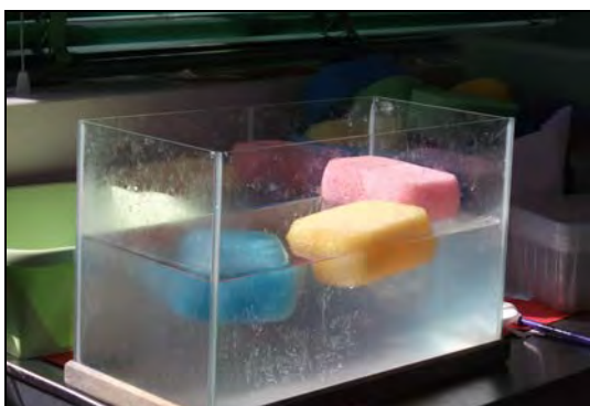
le tre spugne galleggiano con diversa altezza di immersione in funzione della quantità di acqua assorbita. Le spugne sono state lasciate come nella foto a sinistra. All'inizio della attività successiva le tre spugne galleggiano con la stessa immersione.
