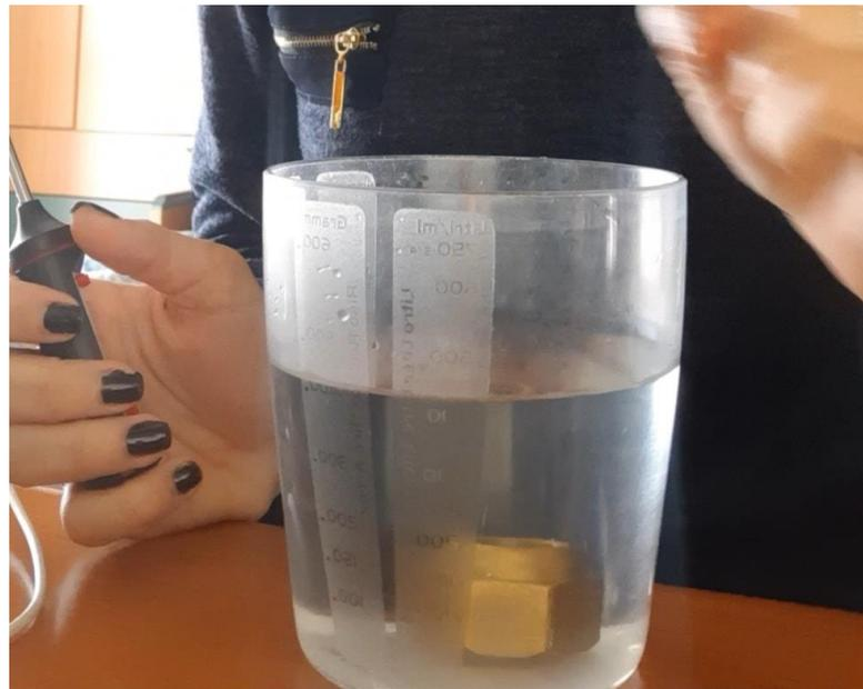
**Figura 32- Cubetto di acciaio freddo immerso in acqua calda**
