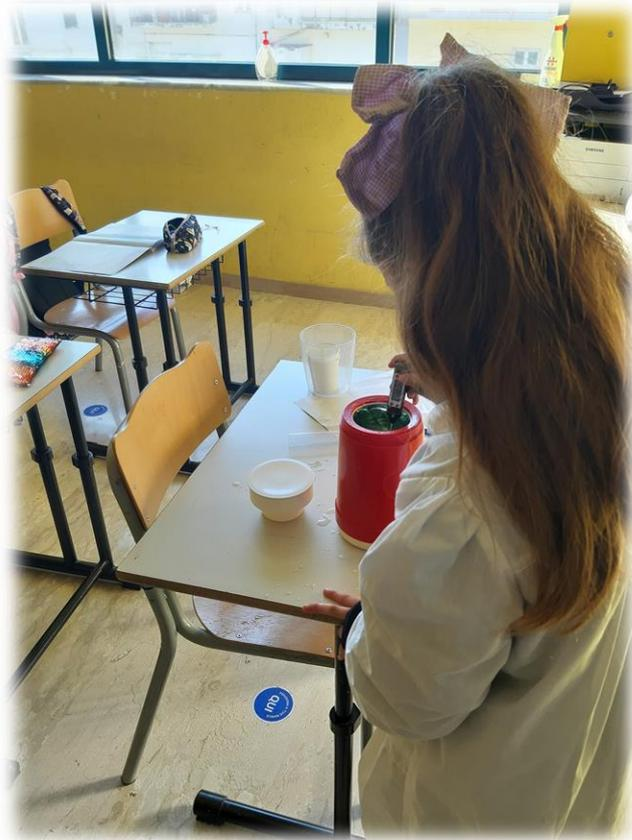
**Figura 35- Misurazione della temperatura del liquido all’interno del termos dopo averlo shakerato**
