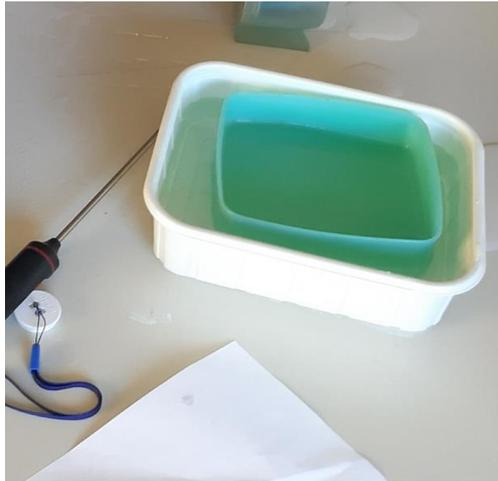
**Figura 20- Il contenitore con il liquido caldo è immerso nel contenitore con il liquido freddo**
