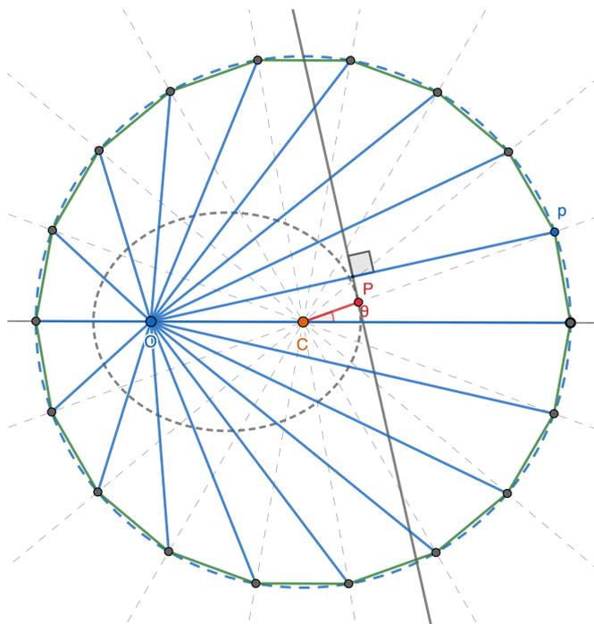
**Figura 7:** Costruzione dell'orbita a partire dal diagramma delle velocità.
