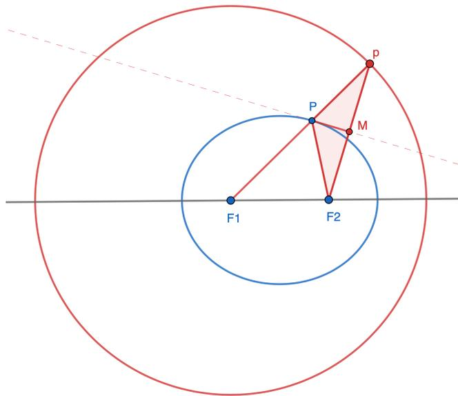
**Figura 1:** Il metodo delle tangenti per la costruzione di un'ellisse. Il punto  $p$ , muovendosi lungo la circonferenza di centro  $F_1$ , genera l'ellisse di fuochi  $F_1$  e  $F_2$ .
