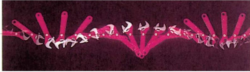
Figura 2 – In assenza di attrito, la chiave ruota e trasla su di un piano. La sua forza peso è bilanciata alla reazione vincolare e non essendo applicata alcuna forza sul corpo, il suo baricentro (puntino bianco) si muove di moto rettilineo uniforme.
