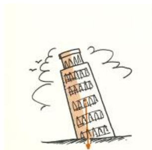
Figura 11 – verticale passante per il baricentro della torre di Pisa che cade entro la base di appoggio
