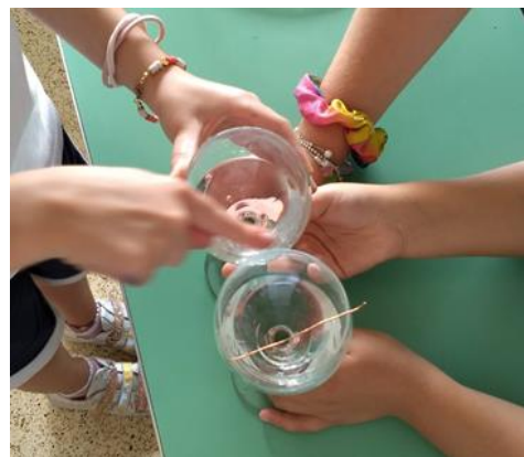
Fig. 34 – Lo strofinio del primo calice fa risuonare il secondo, la vibrazione muoverà la stecchetta.
