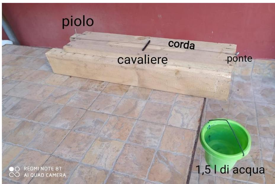
**Figura 4.46** Costruzione del Monocordo
