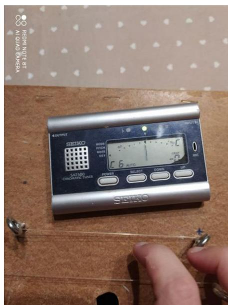
**Figura 4.52** suonando l'ultima corda, della lunghezza di 13,5 cm, otteniamo la nota Do della sesta ottava del pianoforte.
