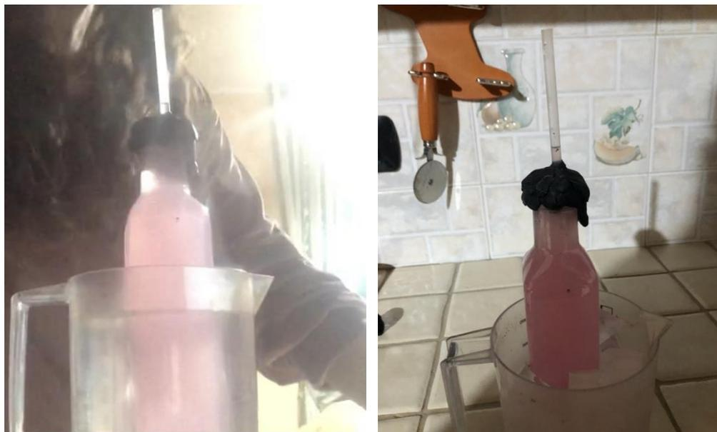
*Figure 9 e 10: Foto ricavate da due dei video da me realizzati inerenti alle attività che trattano la dilatazione termica. Viene mostrato il termoscopio immerso prima in acqua calda e poi nel ghiaccio.*
