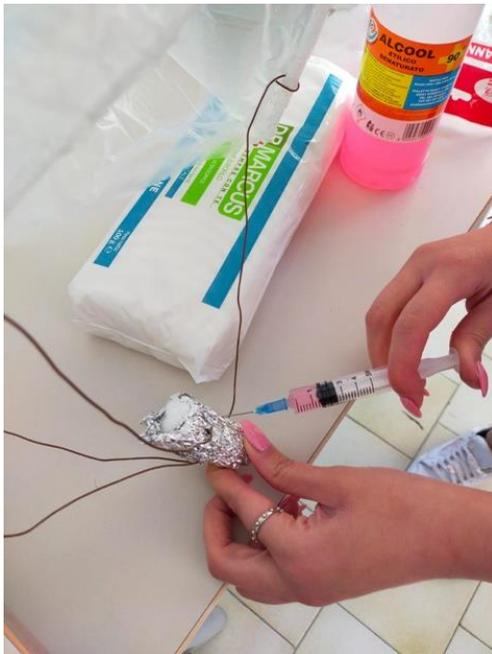
Figura 23: L'alcool viene messo all'interno del cono pieno di ovatta.
