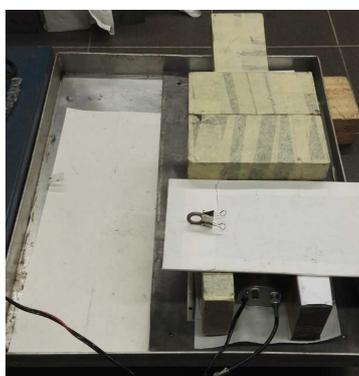
Figura 2.2.57: Sistema di rivelazione schermato con mattoni in piombo.
