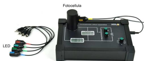
Figura 2.2.40: Apparato per la misura della costante di Planck.
