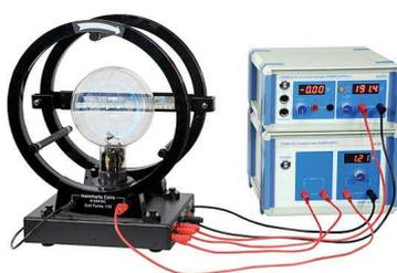
Figura 2.2.21: Strumentazione per la misura della carica specifica dell'elettrone.
