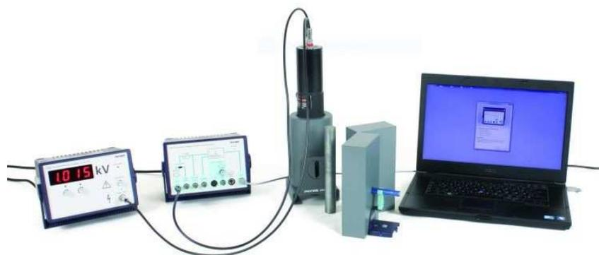
Figura 2.2.49: Apparato sperimentale per l'esperimento di spettroscopia gamma: (partendo da sinistra) alimentatore, multicanale, rivelatore (scintillatore, fototubo e amplificatore), mattoni in piombo per schermare e PC.
