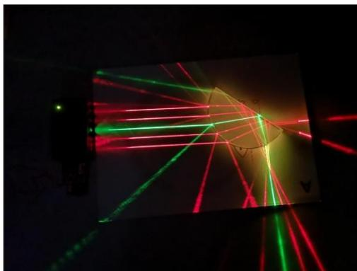
Figura 42 La stessa lente della figura precedente con i cinque raggi paralleli.
