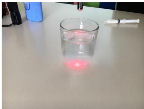
*Figura 114 La luce rossa della torcia proviene dall'alto, in parte si riflette sulla superficie dell'acqua in parte attraversa l'acqua, incontra una lente sulla base del bicchiere e forma la macchia rossa sul tavolo.*
