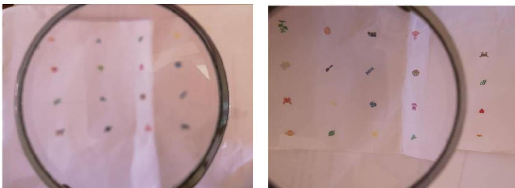
Figura 120: La lente di ingrandimento a sinistra è posta lontano dal foglio: le immagini sembrano sbiadite; la lente di ingrandimento a destra è posta vicino ai disegni: essi appaiono ingranditi.
