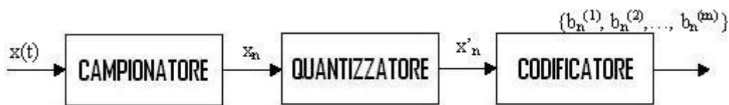
Figura 26. Schema circuitale del convertitore analogico digitale.
