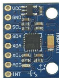
Figura 20. Sensore con microprocessore MPU-6050.
