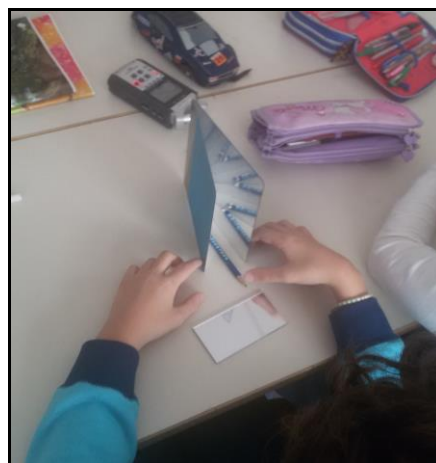
Figura 12: riflettore angolare – due specchietti “incernierati” in modo da visualizzare immagini multiple al variare dell'angolo di apertura
