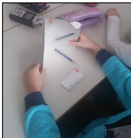
Figura 12: riflettore angolare – due specchietti “incernierati” in modo da visualizzare immagini multiple al variare dell'angolo di apertura
