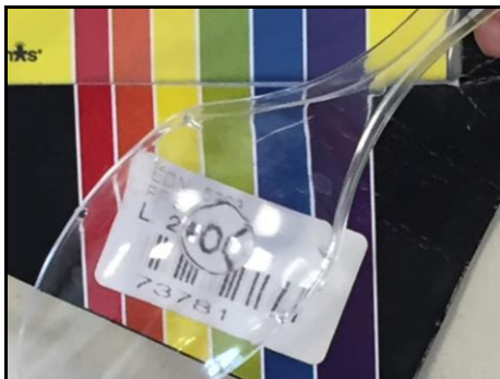
Figura 2: una goccia d'acqua fatta con una pipetta si comporta come una piccola lente di ingrandimento
