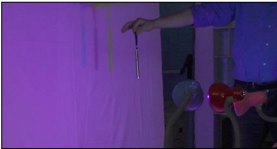
Figura 38: ombre giallo, magenta e ciano prodotte da luci rosso, verde e blu
