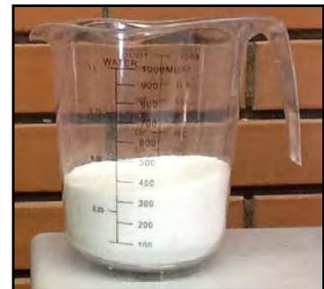
Per misurare il volume dei granulari occorre tenere il becher in piano e scuoterlo in modo da livellare la superficie della materia granulare.
