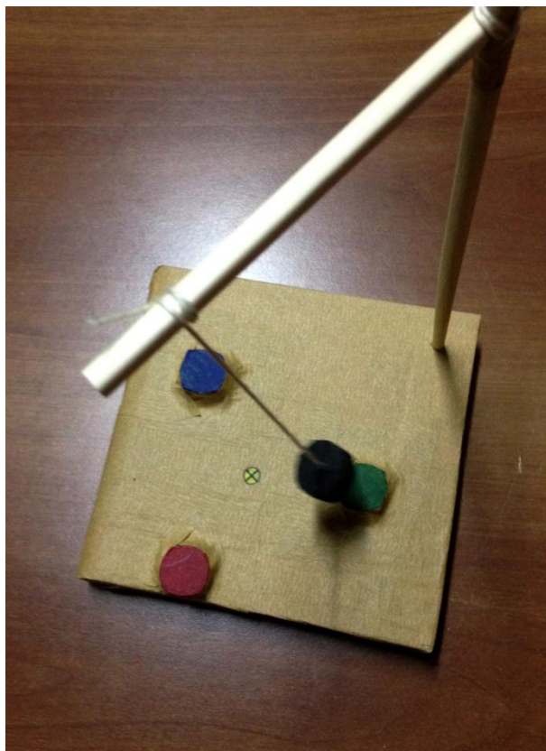
Figura 20. Pendolo caotico a tre magneti realizzato per questo lavoro con materiali molto semplici.
