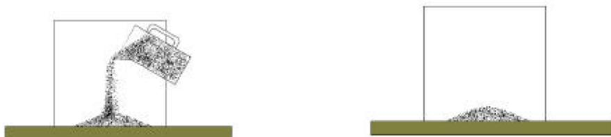
Si traccia con il pennarello sul foglio il profilo del mucchietto di materiale sciolto che si è formato. Si rimuove poi il materiale sciolto e infine si misura, utilizzando il goniometro, la pendenza dell'angolo che il profilo tracciato sul foglio forma con il banco di lavoro.
